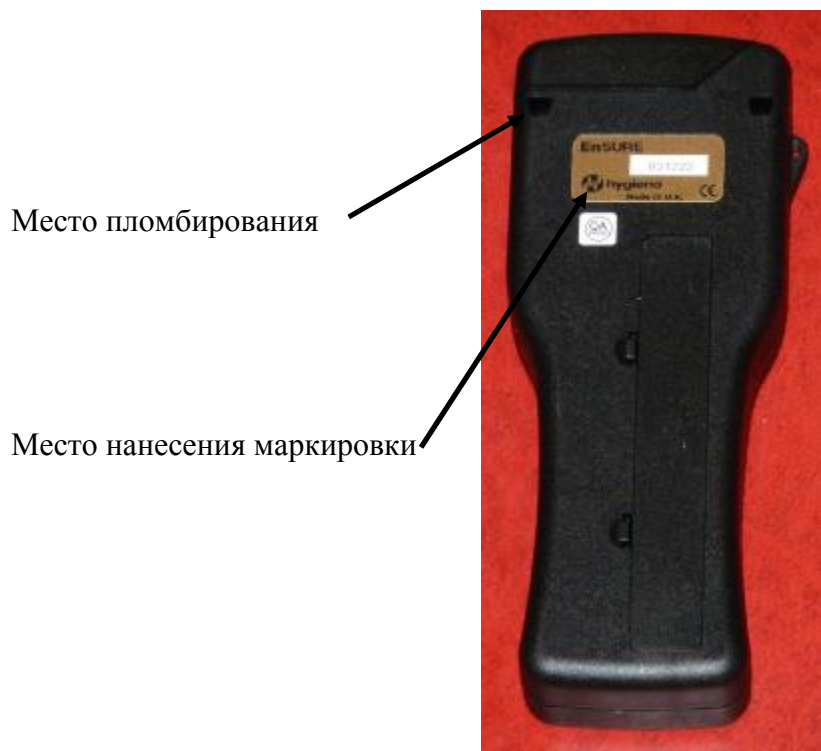
Рисунок 2 – Места нанесения маркировки и пломбирования
