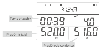
Figura. 5 interfaz de inicio de la prueba de presión de mantenimiento
