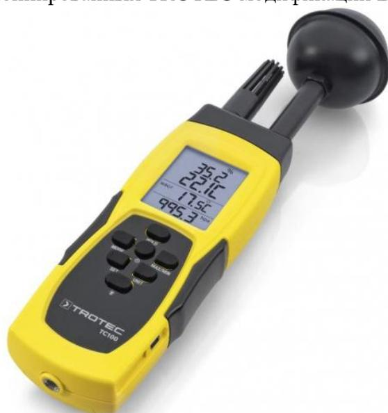
Рисунок 5 – Общий вид измерителей комбинированных TROTREC модификации TC100
