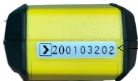
Рисунок 5 – Место нанесения заводского (серийного) номера анемометров модификаций ВА06 и ВА16
